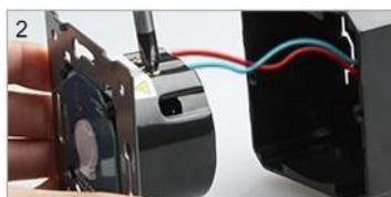
Подключите провода винтами фаза – L, лампа – L1
