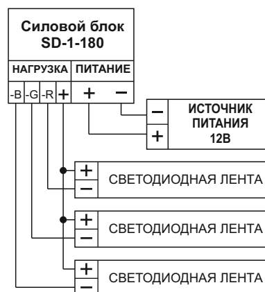
Схема подключения (одноцветная лента)
