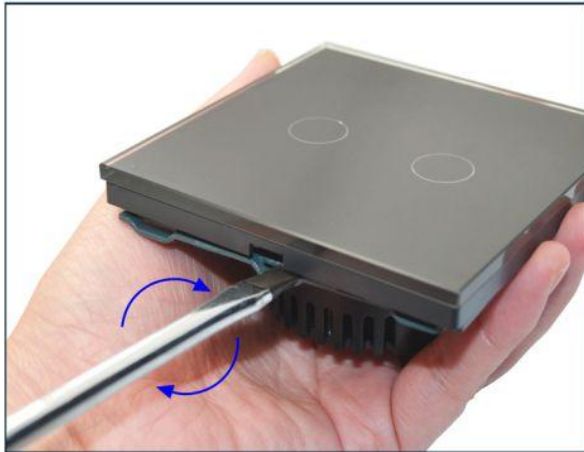
1. отсоедините лицевую панель используя отвертку
