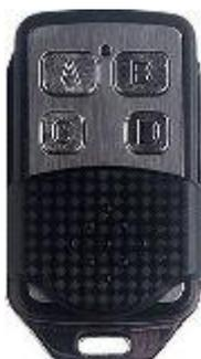
Программируемые клавиши «А», «В», «С» включают и выключают свет по заданным зонам. Клавиша «D» выключает все зоны одним нажатием.
